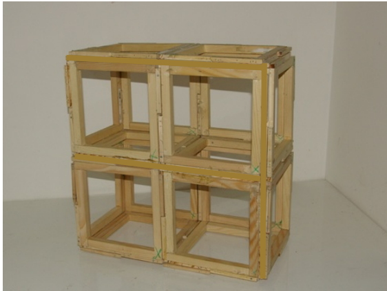
prototipo in scala ridotta - manufatto di 2 blocchi - totale 18 pannelli
