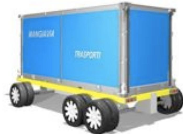
Il sistema prevede oltre al container, un rimorchio allestito in modo che serva come unità di trasporto dei container sia in stato carico stato stoccato; il sistema Octavius destinato alla intermodalita' media strada ferrovia quindi e' fatto di 8 container +trailer.
